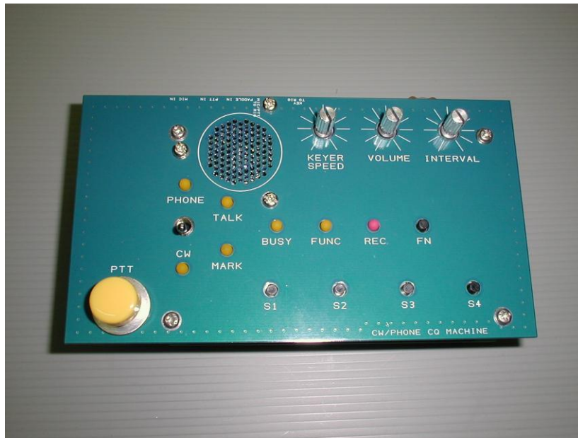
図 23 パネル正面(ツマミ取り付け前)
