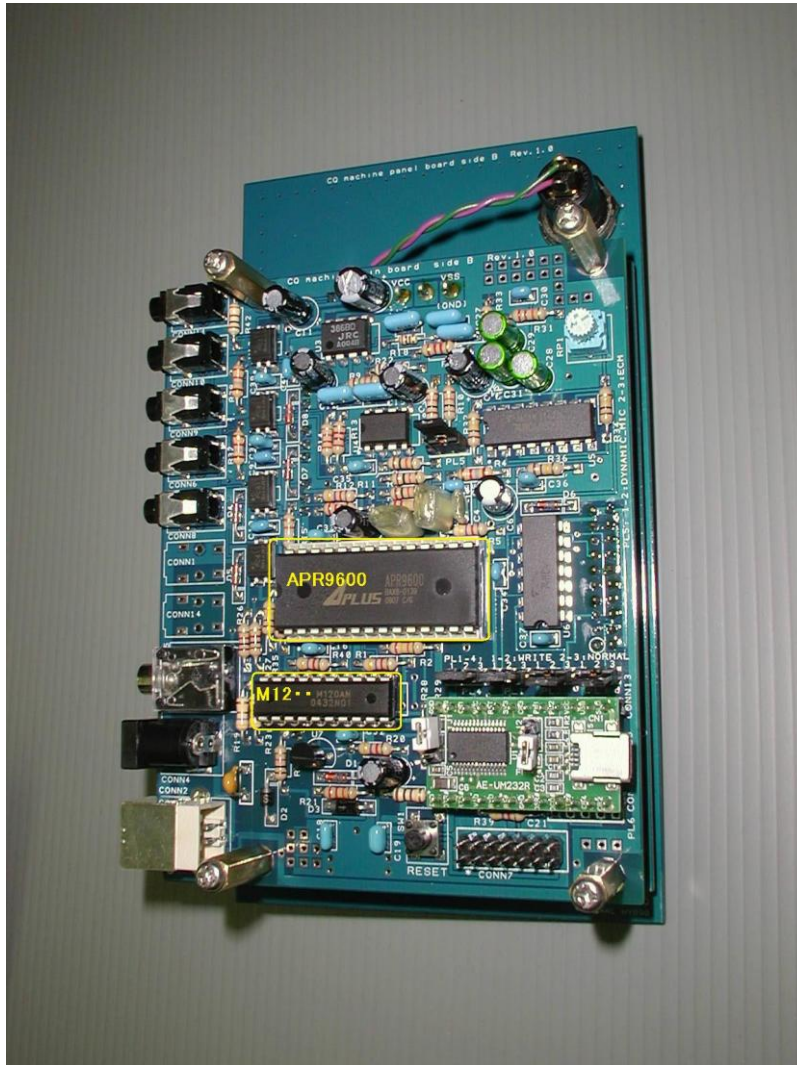
図 5 IC 挿入位置と向き
